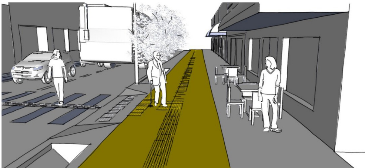
Figura 7. Faixa Livre, demarcada em dourado – Fonte: Manual da Calçada Acessível de Petrópolis.
