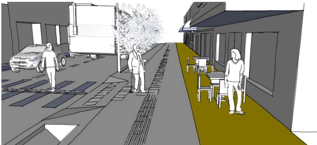
Figura 9. Faixa de Acesso, demarcada em dourado – Fonte: Manual da Calçada Acessível de Petrópolis.
