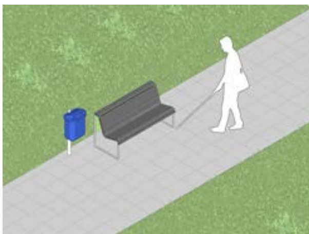
Figura 58 – Mobiliário urbano não demarcado será percebido com o uso da bengala. Excesso de demarcações produz confusão.
